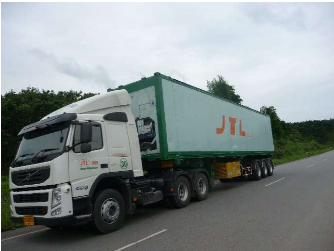
【45フィート背高リーファーコンテナを積載して走行するトレーラー】
